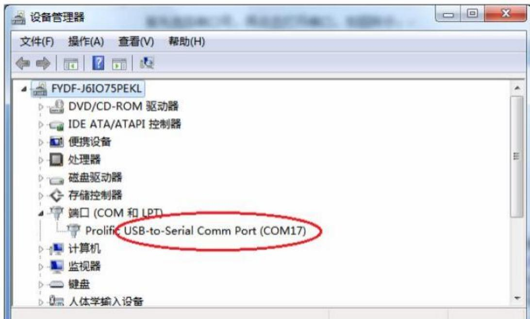
(4) 参照 MDC26 GSM/GPRS 设备自适应的波特率，设置合适的波特率，在输入框输入“at”，点击“发送”，窗口会显示“at”和返回的“OK”，说明 SSCOM 设置正确，并可以使用。
